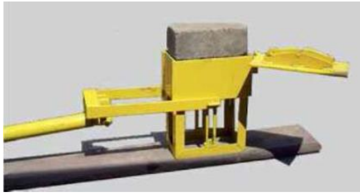
شكل (٦) الكابسة اليدوية التي استعملت للطابوق الطيني الغير مفخور
